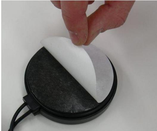
Sollte die Antenne anderweitig verbaut werden, ist unbedingt darauf zu achten, dass die selbstklebende Seite immer in Richtung des Himmels zeigt, da diese Seite die aktive Antennenseite ist.
