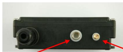
Anschluss der GSM- Antenne
